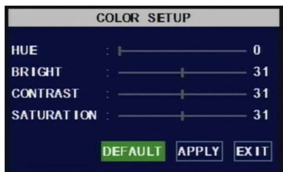
E’ possibile modificare colore, lucentezza, contrasto e saturazione per ogni singola telecamera.
