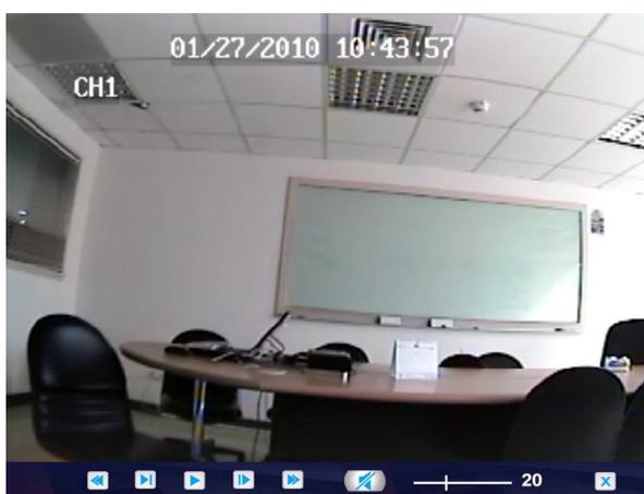
I filmati possono essere visionati e mandati avanti con velocità 2x, 4x e 8x , rallentati 1/2x, 1/4x, 1/8x, o visti in modo normale, messi in pausa e visualizzati fotogramma per fotogramma utilizzando la barra di controllo e si può modificare il volume. Finita la visualizzazione del filmato il sistema tornerà al menu precedente.
