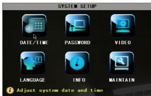
Il menu del sistema permette di configurare l'ora, le password, la lingua e i settaggi video. Inoltre si hanno le informazioni di sistema e è possibile controllare il firmware della macchina per gli aggiornamenti.
