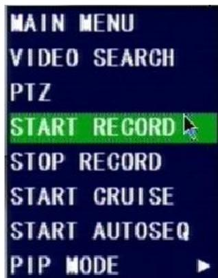
Nel menu pop-up: ci sono 2 funzioni **START RECORD** e **STOP RECORD**. Registrazione manuale e stop registrazione. La funzione di inizio registrazione manuale funziona solamente quando il settaggio   stato impostato come segue:
