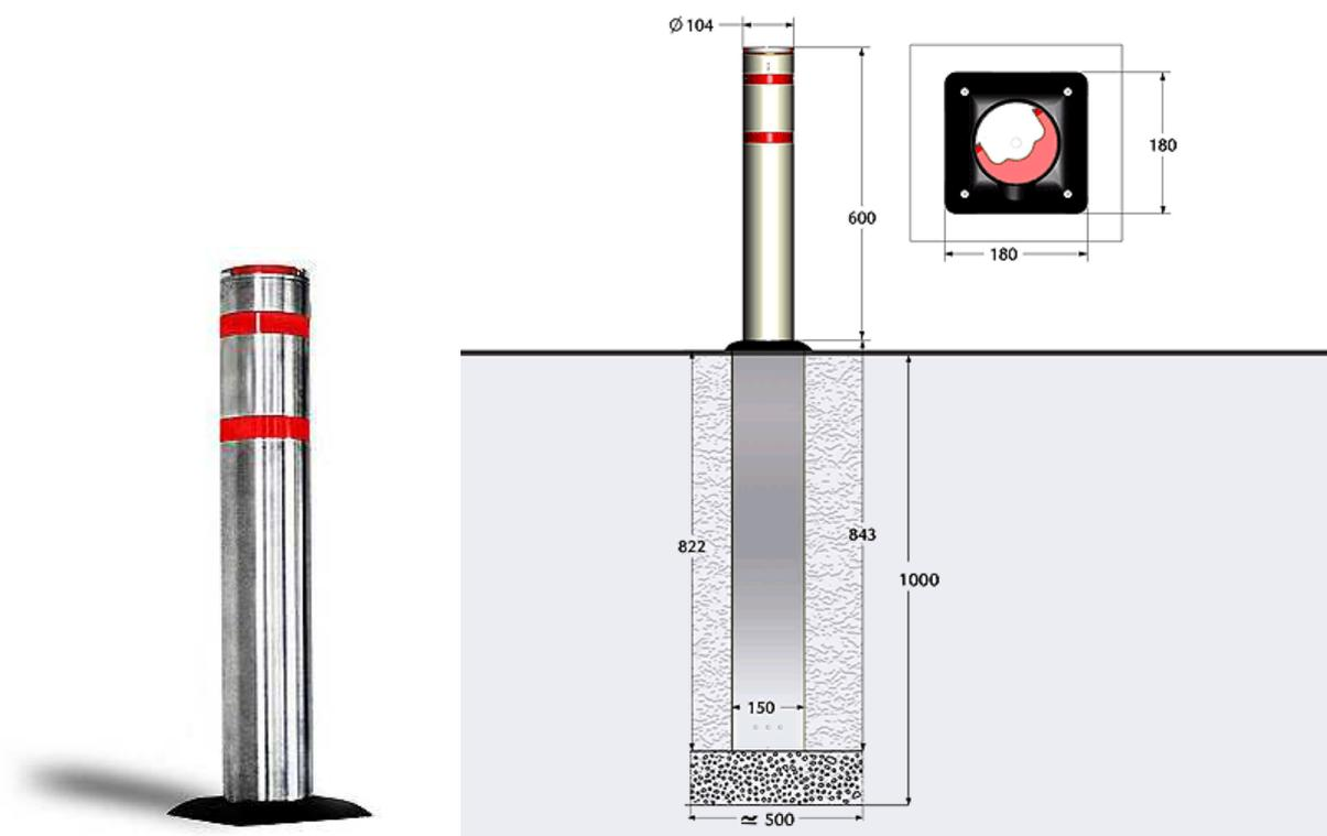
Il palo retrattile AR860 è realizzato, per quanto riguarda l'equipaggio mobile (tubo tondo) in acciaio inox AISI 304 elettro-lucidato, mentre il contenitore (tubo quadro) è in ferro zincato a caldo. Tutti i componenti interni ed esterni sono realizzati in acciaio inox AISI 304. Ottima resistenza agli agenti atmosferici.
